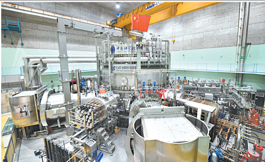
全超导托卡马克核聚变实验装置(EAST) 新华网图
