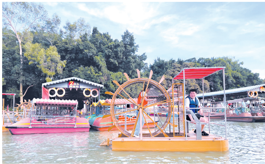
风车船需两人配合,一人踩动风车,另一人坐船头控制方向
