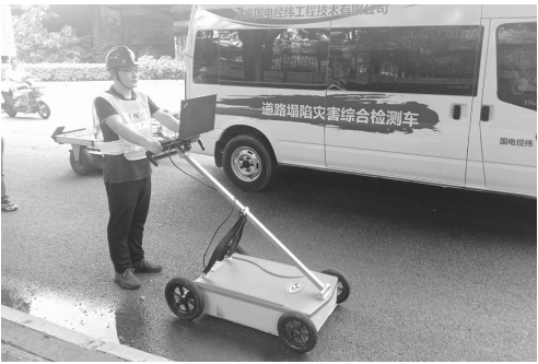
探地雷达探测路边角落位置 工作人员使用便携式手推
