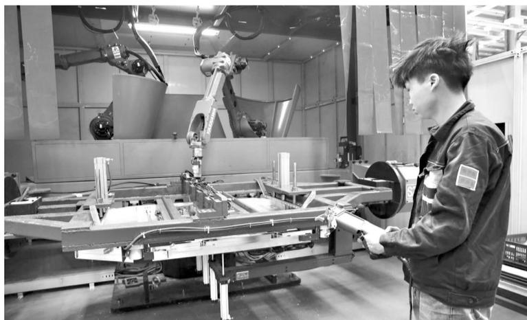
焊接工作基本由机器人完成,工作人员只需设定好程序
