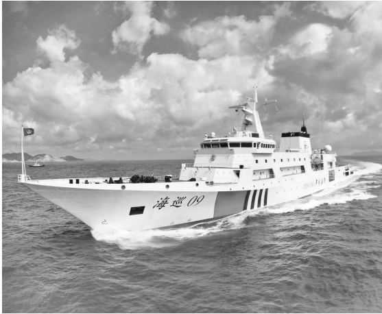
“海巡09”满载排水量1.3万吨
