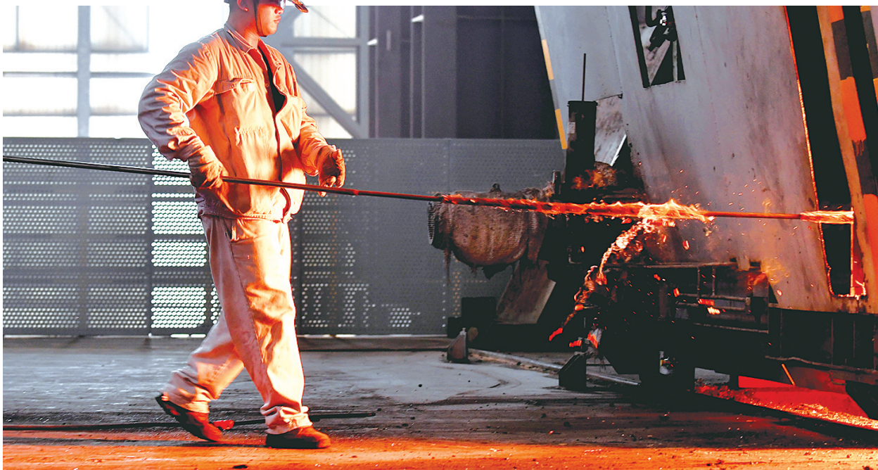
操枪工正在测温取样
