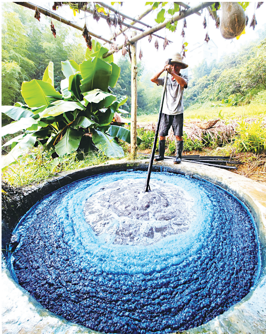
“打蓝”是非常关键的一道工序,可让熟石灰与马兰草浸出液充分反应
