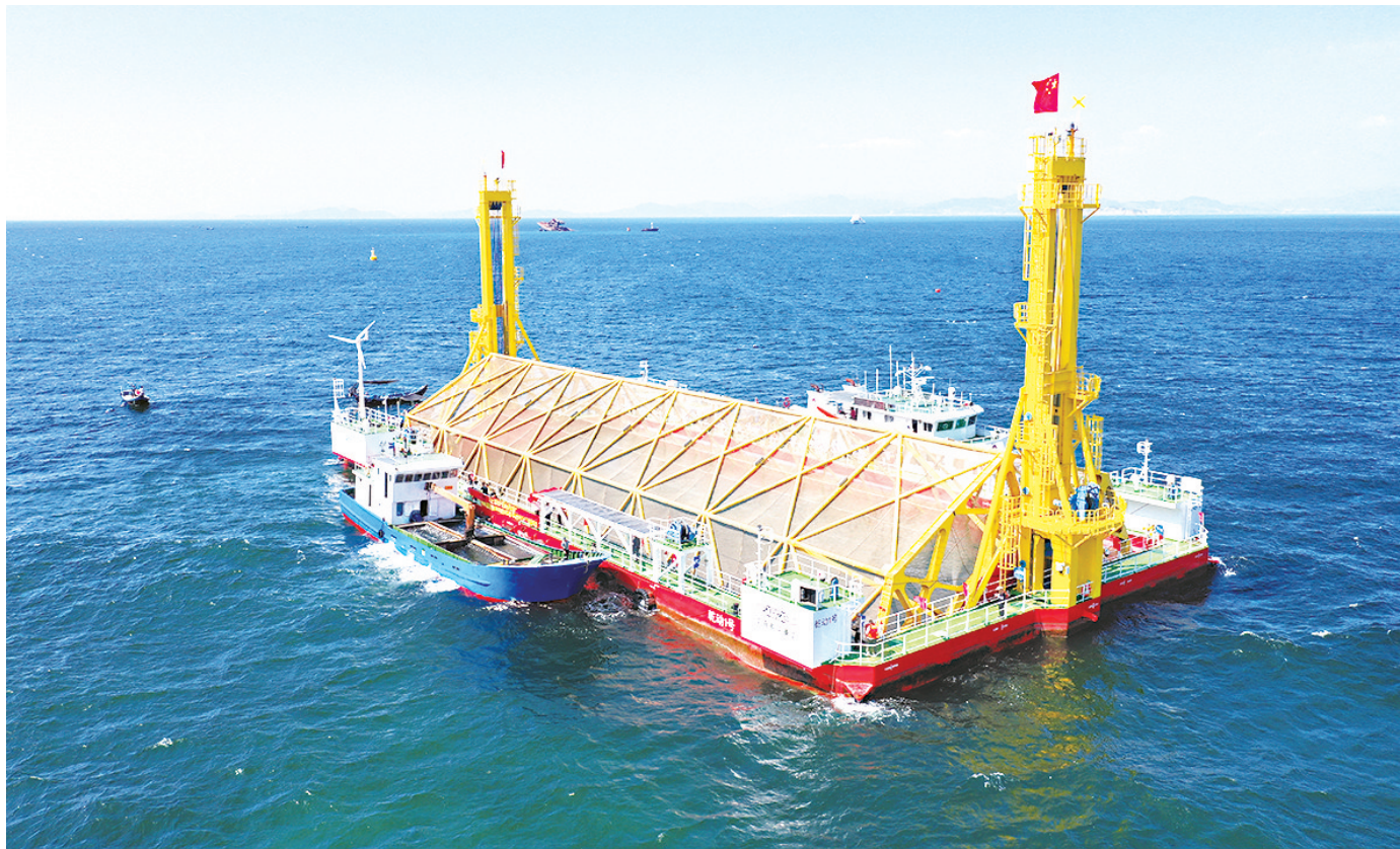
“乾动1号”由结构浮体、养殖网箱、旋转机构、提升机构四大部分组成
