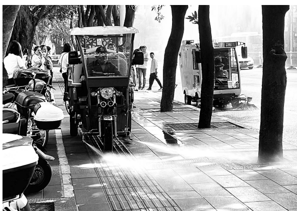
电动高压冲洗车正在对人行道进行深度冲洗
