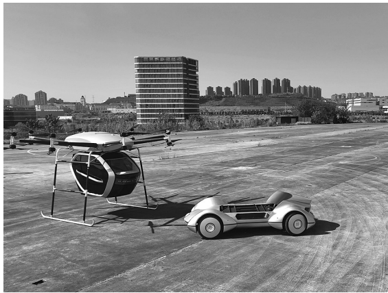
载人级两座智能分体飞行汽车工程样车(北京理工大学供图)
