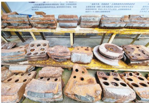
掘进过程中损耗的盾构刀头和部件
