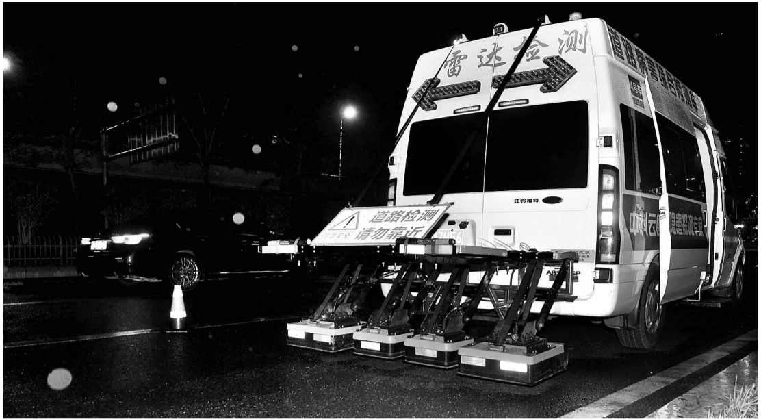
装有探地雷达系统的道路检测车
