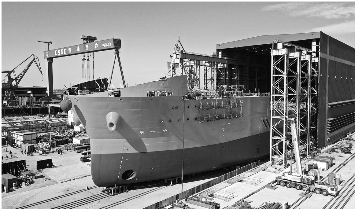
大洋钻探船设计排水量达4.2万吨
