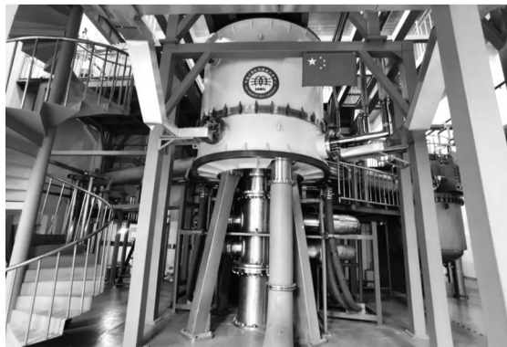
稳态强磁场实验装置混合磁体(中科院合肥研究院供图)
