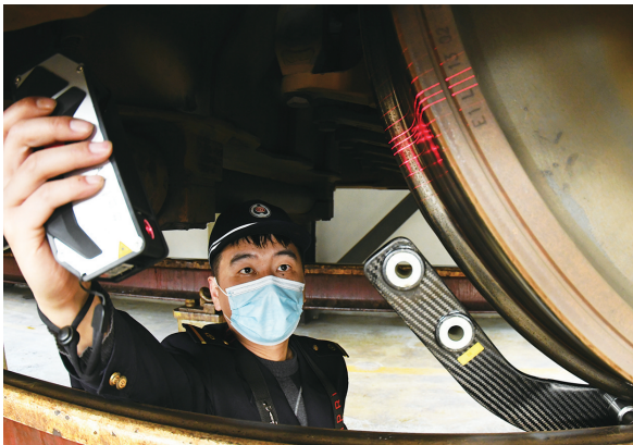
机械师彭兴正在测量动车轮对的磨损数据
