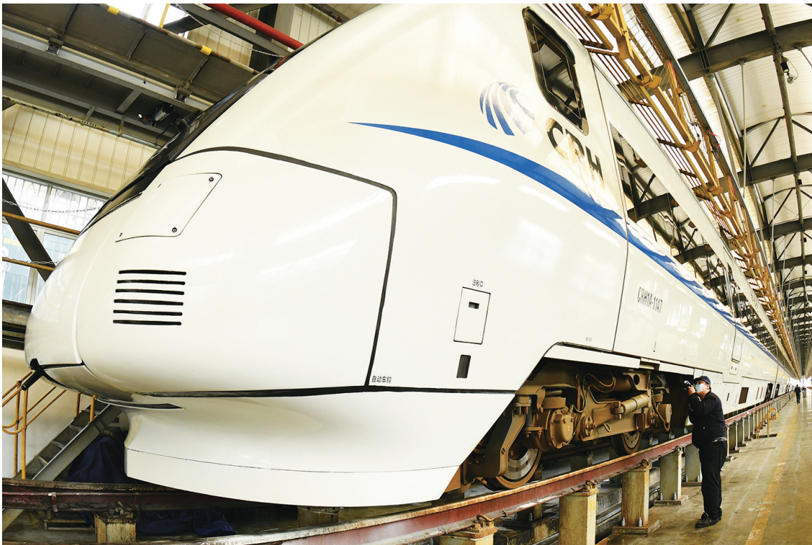
福州动车所机械师李道佑正在进行动车组一级修作业
