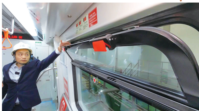
4号线列车创新配备可灵活打开的透气窗,遭遇突发紧急情况迫停时,乘客可打开透气窗
