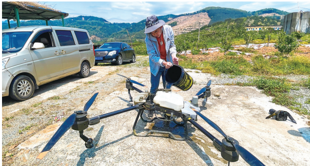
无人机一次可装载40斤水量,15分钟可喷洒超4亩
