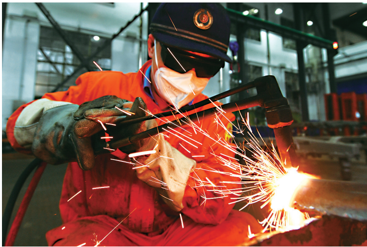
熔接工把补强件切割成合适形状
