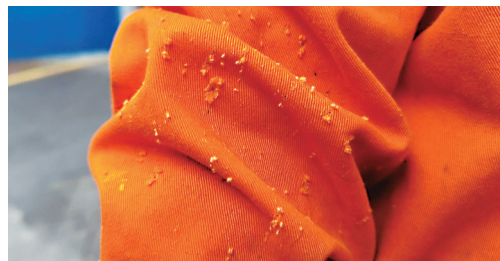
阻燃服表面被火星烧出密密麻麻的小洞
