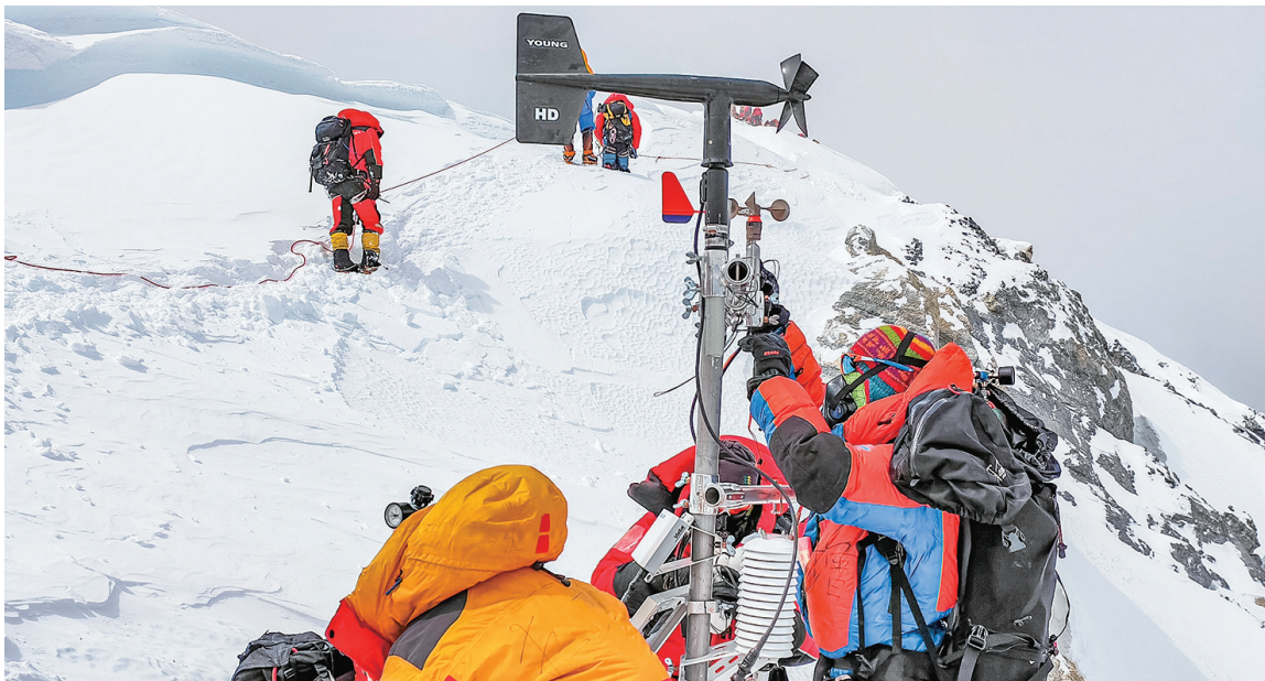
科考登顶队员在珠峰海拔约8830米处维护升级自动气象站
