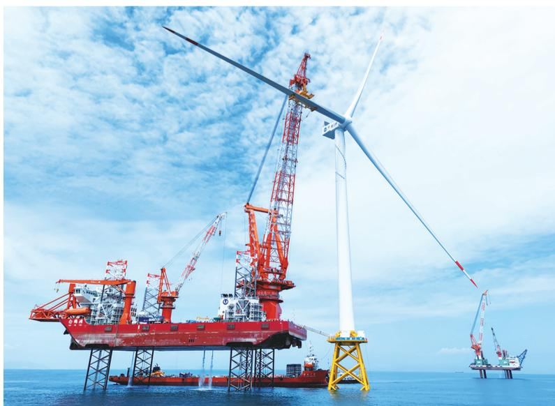
执行吊装16兆瓦海上风电机组的“白鹤滩”号(左),是目前我国最先进的自升自航式一体化风电安装平台之一
