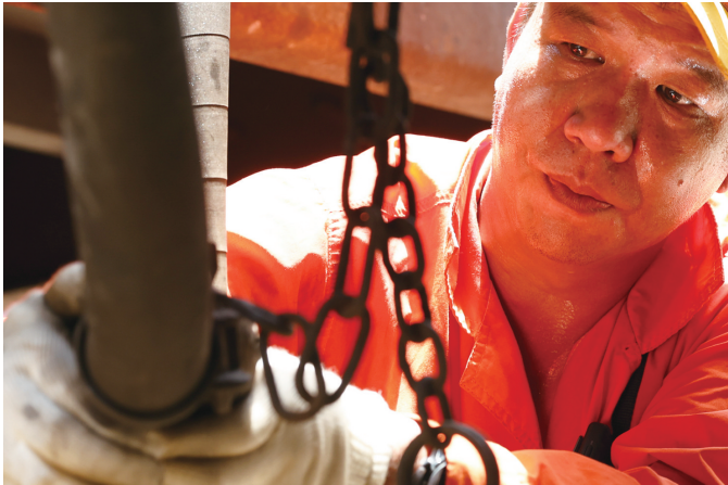
郭榕辉正在车辆连接处接风管
