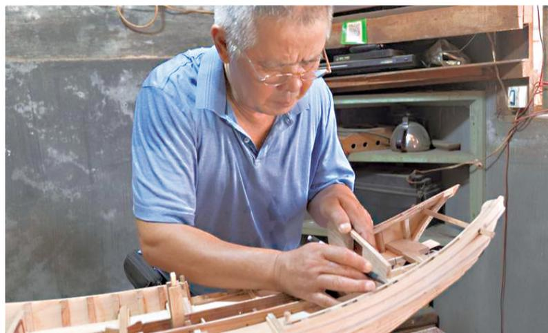
苏仁叠在安装水密隔舱挡板
