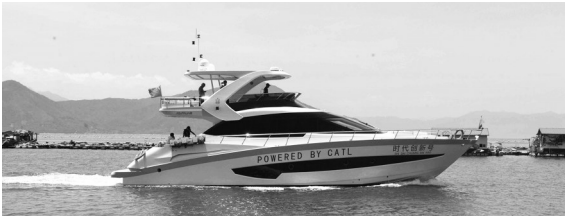
纯电动多功能游艇“时代创新号”采用宁德时代磷酸铁锂动力电池,是国内首艘自主研发的满足中国船级社最新规范认证的高端游艇
