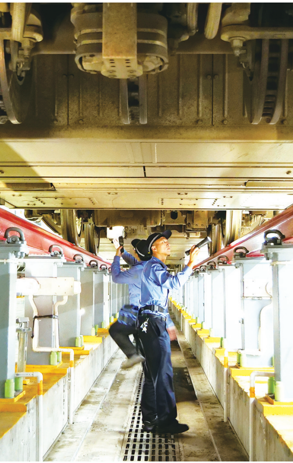
动车组机械师在复兴号智能动车组下方检查走行部件
