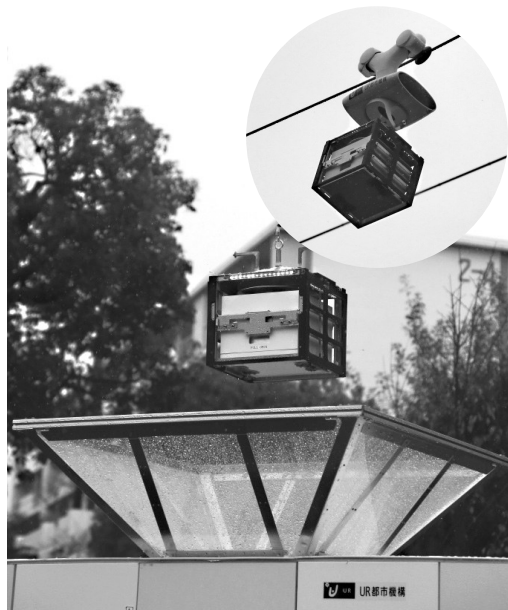
空中索道机器人在面向媒体的试验说明会上演示将商品放入取货柜
