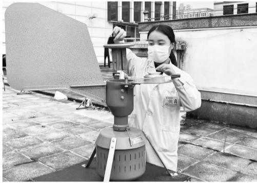
花粉采样设备放置在露天旷处,陈婷团队的小岳在更换收集花粉的金属股
