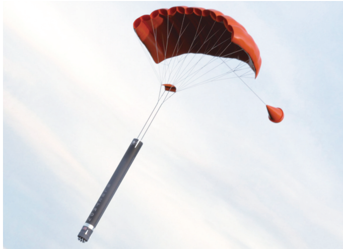
▲美国电子号火箭第一级利用降落伞回收
