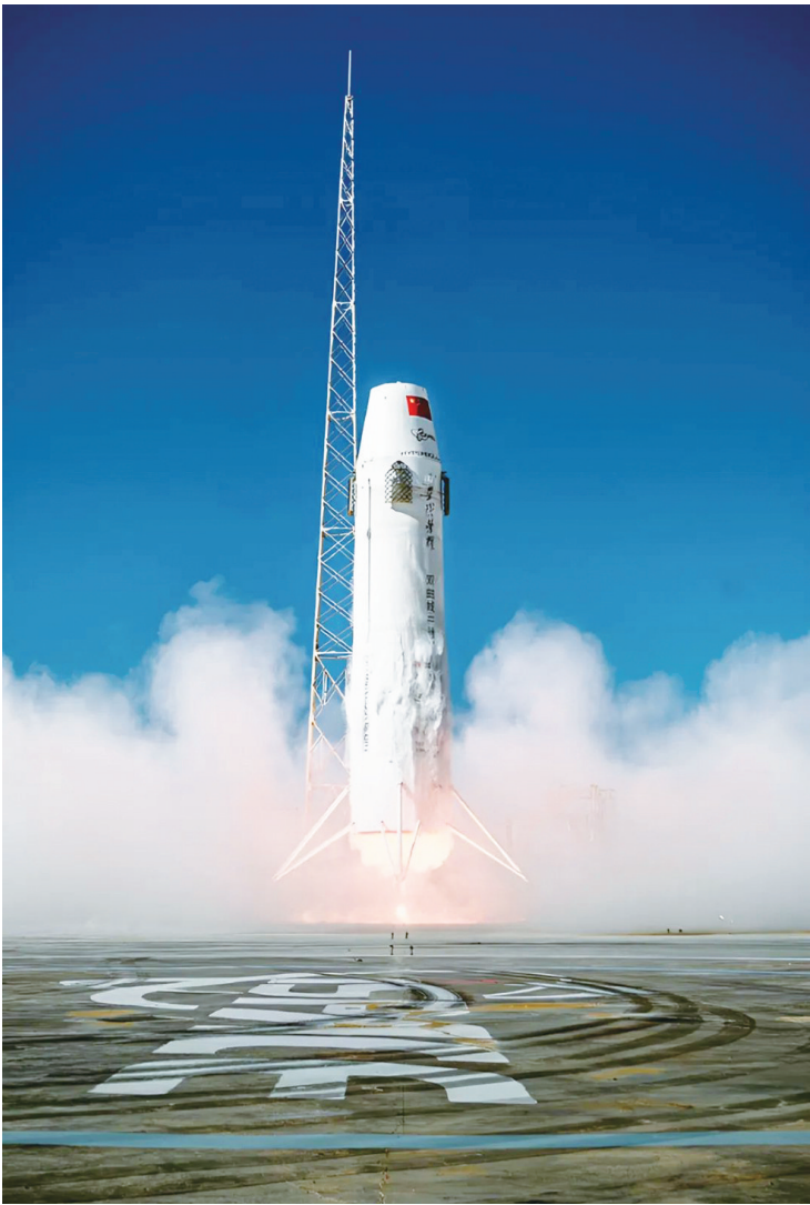
我国“双曲线二号”进行一子级回收试验
