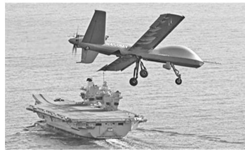
「莫哈维」无人机在英国「威尔士亲王」号航母上进行起降测试
