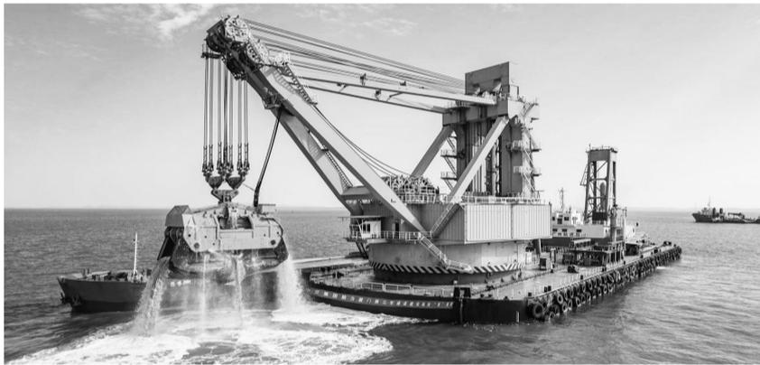
世界最大抓斗挖泥船“金广”投入厦门第三东通道建设施工
