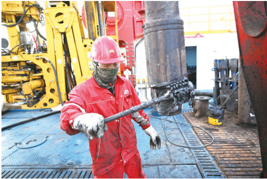
工作人员在“深地塔科1井”钻井平台为钻头涂抹润滑油
