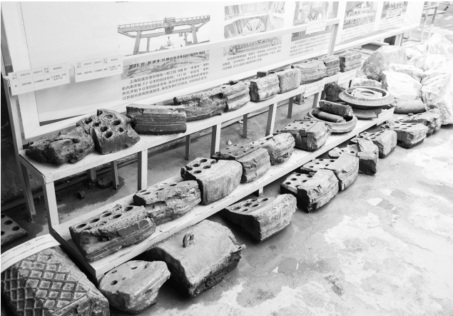
项目上摆放着碎石及损坏的盾构机刀具、搅拌棒等部件
