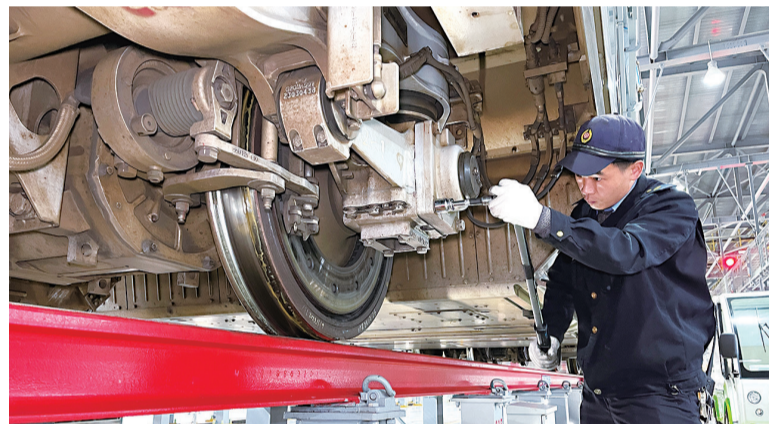
数字化扭力扳手上装载了微型计算机,可提前计算需要紧固的螺栓数量
