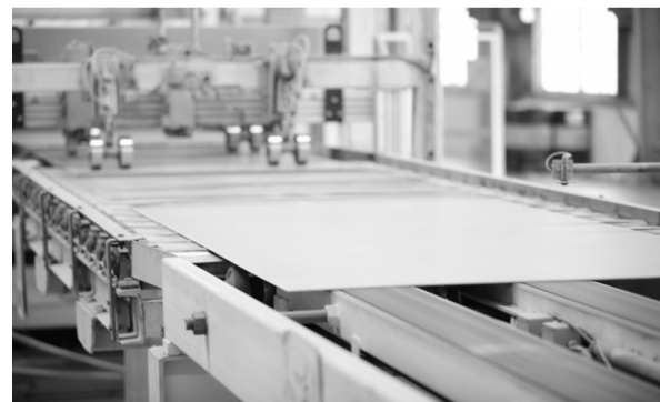
建瓯福人木业人造板厂——全国首条菌草中纤板生产线
