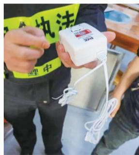
断电关闭状态的燃气报警器
