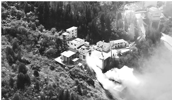
130吨级可重复使用液氧煤油发动机,近日完成2次起动机地面点火试验
