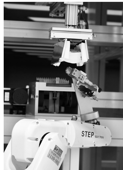
中国电信展台,机械臂正在对鞋底进行喷胶
