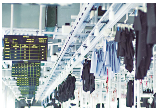
安踏智慧工厂的吊挂系统
