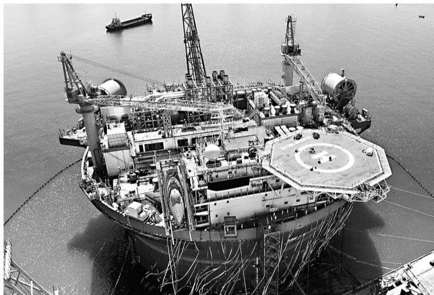
亚洲首艘圆筒型浮式生产储卸油装置“海葵一号”
