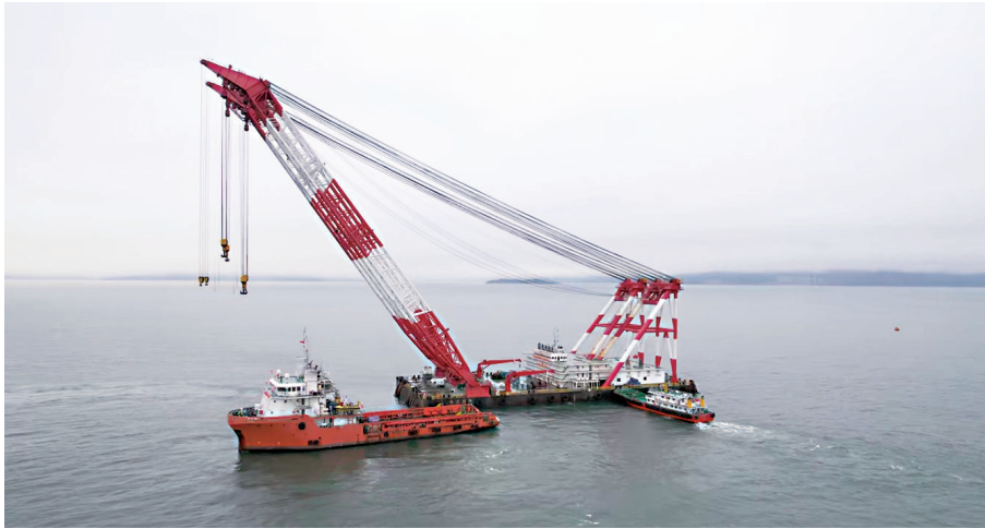
“长大海航”和“长宁101”成八字方向,协助风电施工作业船舶抛锚
