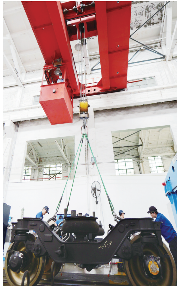
天车是检修库中非常重要的设备,正吊着重达6吨的火车转向架
