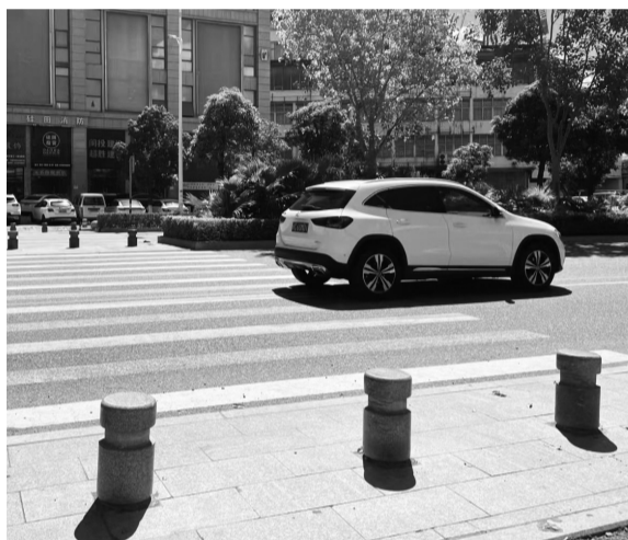
晋江段的缺口安装了石柱,防止机动车掉头
