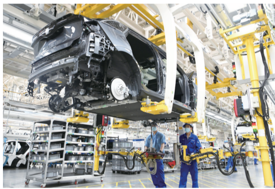
工人在上汽集团乘用车福建宁德基地总装车间生产线上进行车身零部件组装
