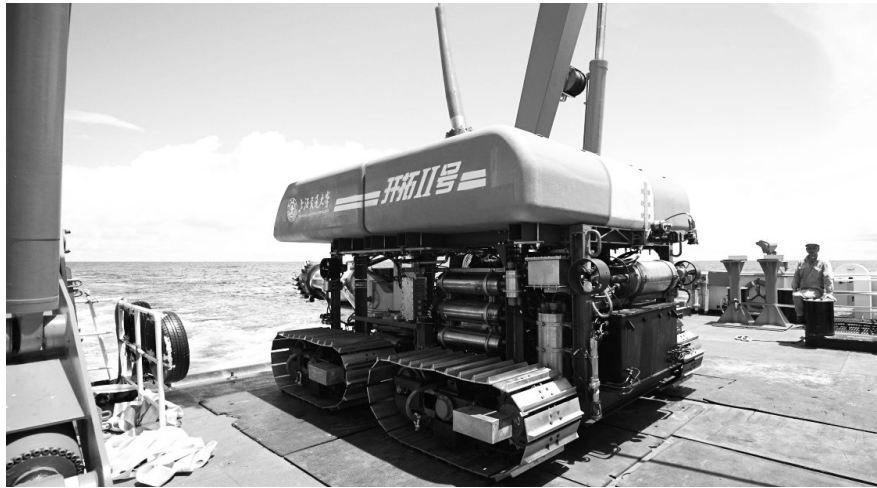
上海交通大学自主研制的深海重载作业采矿车工程样机“开拓二号”(6月20日摄)
