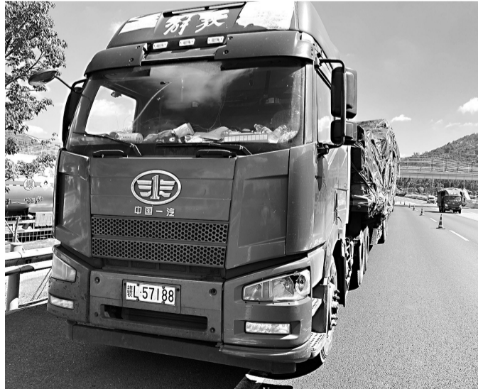
▲螺丝松动,两个轮胎先后脱落
