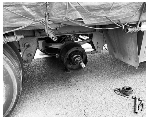
▲螺丝松动,两个轮胎先后脱落
