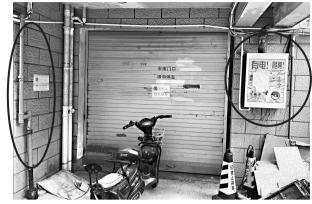
汽车充电桩与燃气管道距离约两米
