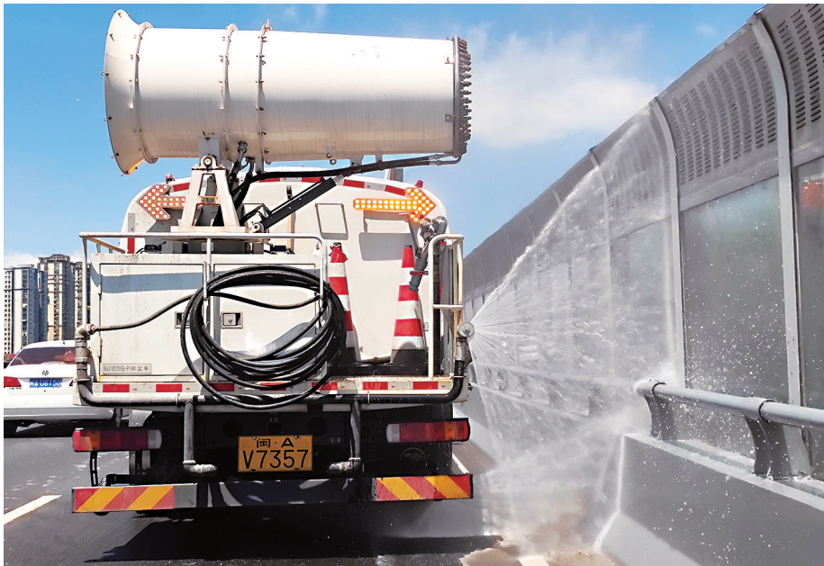
雾炮车后端改造了几段出水管,分别给幕墙冲洗喷头、路沿冲洗喷头等供水,变成“一车多能”
