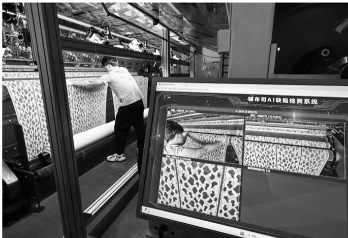
该公司自主研发了蕾丝丝花边面料智能缺陷检测系统, 自动检测布面疵点(长乐区委宣传部供图)
