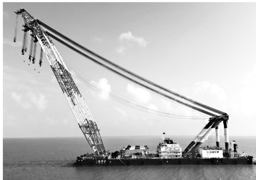
船体总长165米,最大起升高度120米
