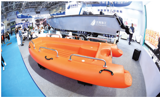
使用聚乙烯材料制造的船舶,被厂商称为“永不沉没”
