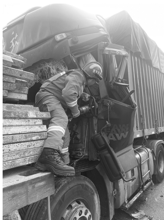
消防员对驾驶室进行扩张,抢救司机
